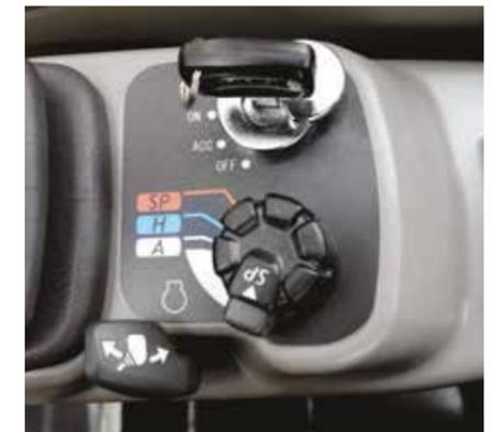
Операторы могут сохранять до 10 дополнительных настроек расхода гидравлического масла (и давления гидравлического масла — опция по заказу), что позволяет им легко и быстро менять навесное оборудование без необходимости каких-либо механических регулировок.
